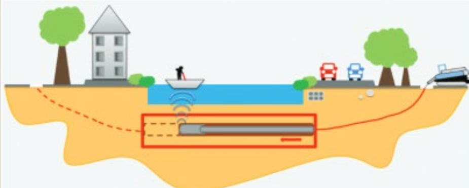
Spülbohrverfahren (Prinzipdarstellung) Quelle: BMVI
